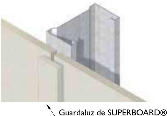
fig. 5.5.7 Junta con perfil de PVC o aluminio
