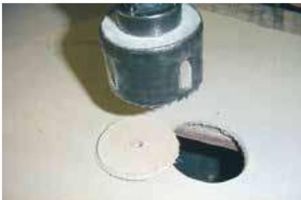
fig. 5.2.3A Perforación con brocas de punta de tungsteno
