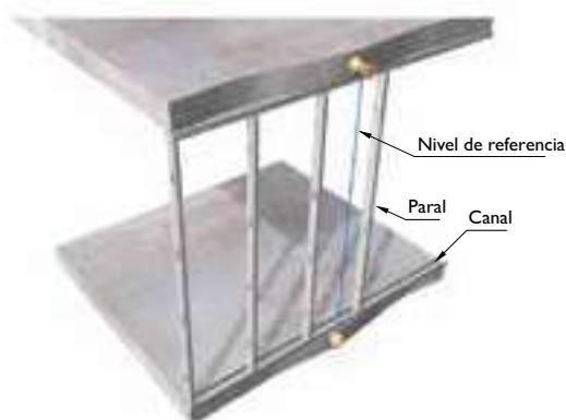
Con una plomada, boquilla o codal, revise la alineación vertical de las losas de entrepiso ubicando el punto más desfasado horizontalmente de todos los niveles, es decir, ubicando aquel que está más alejado del perímetro de diseño asumiendo éste como el punto de referencia que debe corregir la fachada.
