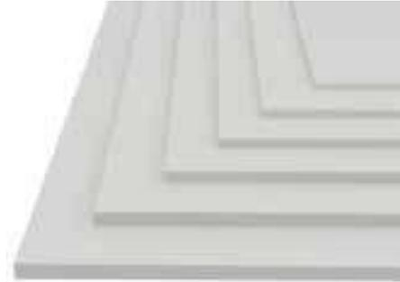
Superboard® es una placa plana de cemento fraguada mediante proceso en autoclave (alta presión, humedad y alta temperatura), lo que sumado a una especial selección de materias primas (mezcla homogénea de cemento,
